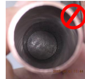
Sin usar nitrógeno
